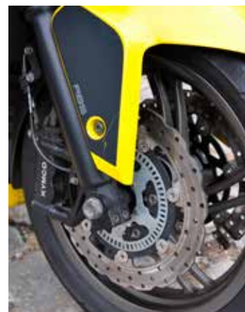
Dikke 280mm remschijven met radiaal geplaatste remklauwen
