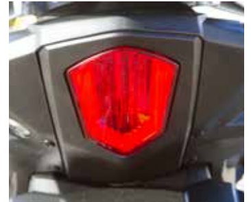
LED verlichting in het achterlicht
